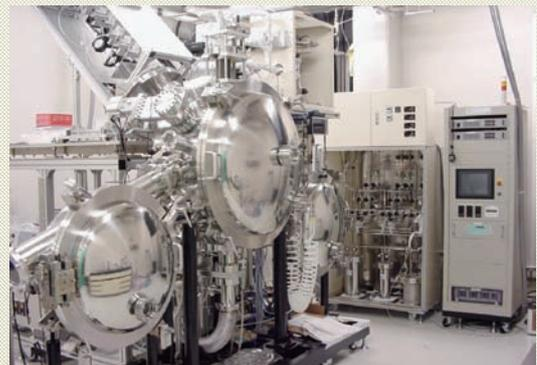
図4 巻き取り型レーザーCVDの外観
